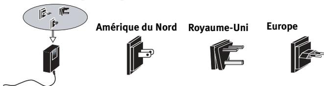
5. Connectez l'adaptateur secteur fourni au port d'alimentation **POWER** du serveur d'impression et branchez-le dans une prise de courant standard.
